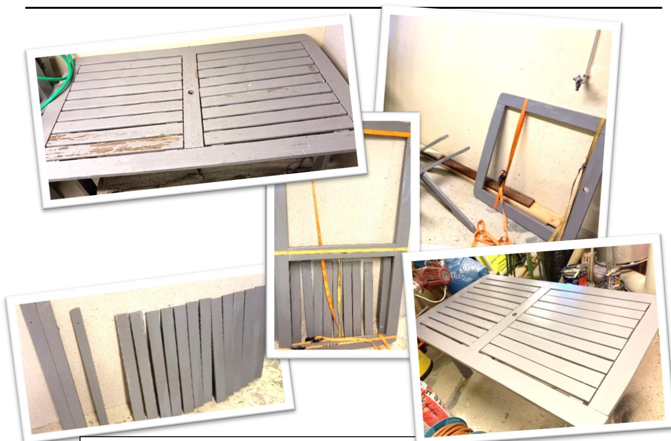
Renovering av en utemöbel: Bild 1: Före isärtagning, 2 och 3: Ramen renoveras och limmas, 4: Gamla och nyttillverkade delar målas, 5: Monterat och färdigmålat – bara 19 stycken till att göra...
